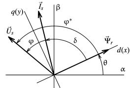
Fig. 2. Location of stator voltage, stator current and rotor flux vectors Рис. 2. Положение векторов напряжения статора, тока статора и потокосцепления ротора
