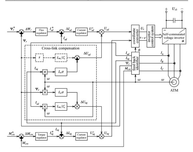
Fig. 3. Block diagram of the control system with independent control of rotor flux and electromagnetic torque Puc. 3. Блок-схема системы управления с независимым управлением потокосцеплением ротора и электромагнитным моментом
