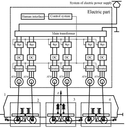
Fig. 1. Electric locomotive as controlled electro-mechanical system: 1 – car body; 2, 3, 4 – bogies Рис. 1. Электровоз как управляемая электромеханическая система: 1 – кузов; 2, 3, 4 – тележки
