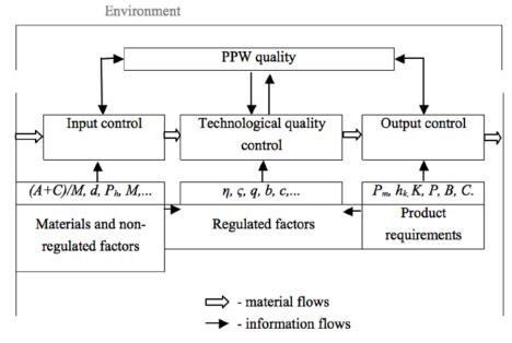
Fig. 3. Model quality control work to consolidate the sand (WCS) quality control model Рис. 3. Модель контроля качества пескозакрепительных работ (ПЗР)
