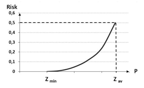
Fig. 6. The schedule of dependence of risk from value of the norm P if KPI is defined as triangular fuzzy number Puc. 6. График зависимости риска от значения норматива P, если ключевой показатель эффективности определен как треугольное нечеткое число
