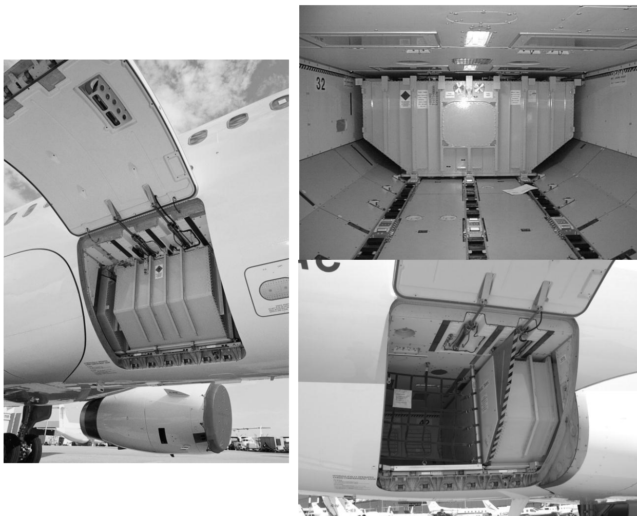
Fig. 3. Installation of additional fuel tanks in the freight hold Rys. 3. Instalacja dodatkowych zbiorników paliwa w luku towarowym
