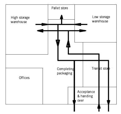
Fig. 1. Materials flow diagram on an architectural design Rys. 1. Wykres przepływu materiału na podkładzie architektonicznym
