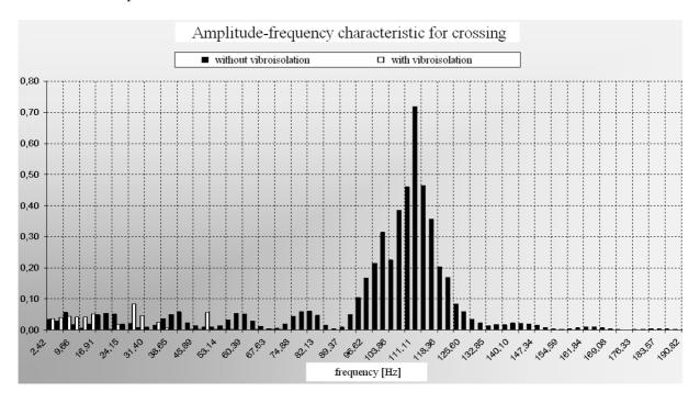
Fig. 12. Amplitude - frequency characteristic for crossing with the application of vibroisolation and without it Rys. 12. Charakterystyka amplitudowo częstotliwościowa przejazdu z zastosowaną wibroizolacją oraz bez niej
