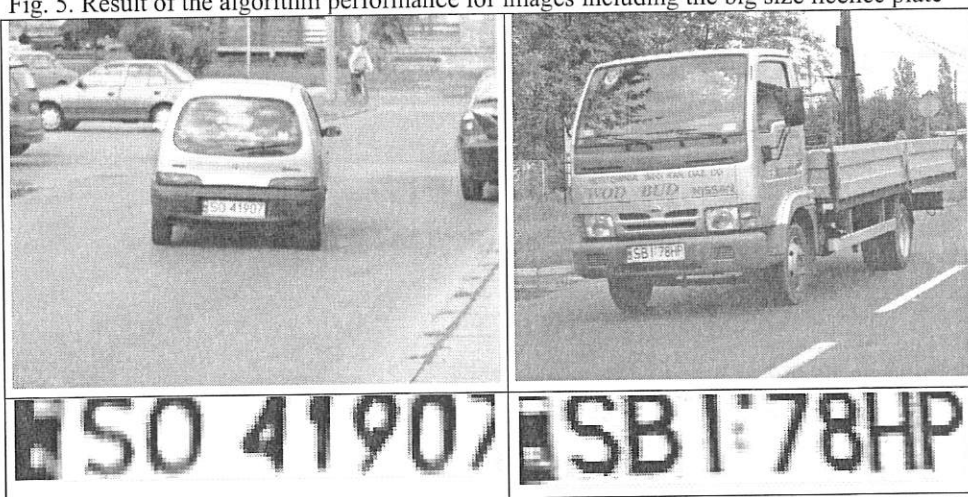
Rys. 6. Rezultat wykonania algorytmu dla zdjęć z tablicami o małych rozmiarach tablicy Fig. 6. Result of the algorithm performance for images including the small size licence plate
