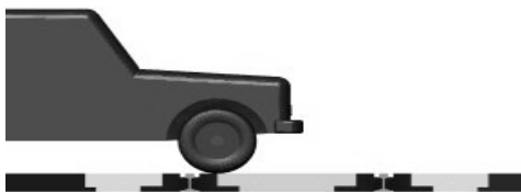
Fig. 4. Visualization of railway crossing in MSC VisualNastran 4D system Rys.4. Ujęcie pojazdu w czasie symulacji (1 – wjazd przedniego koła na płytę, 2 – zjazd przedniego koła z płyty)
